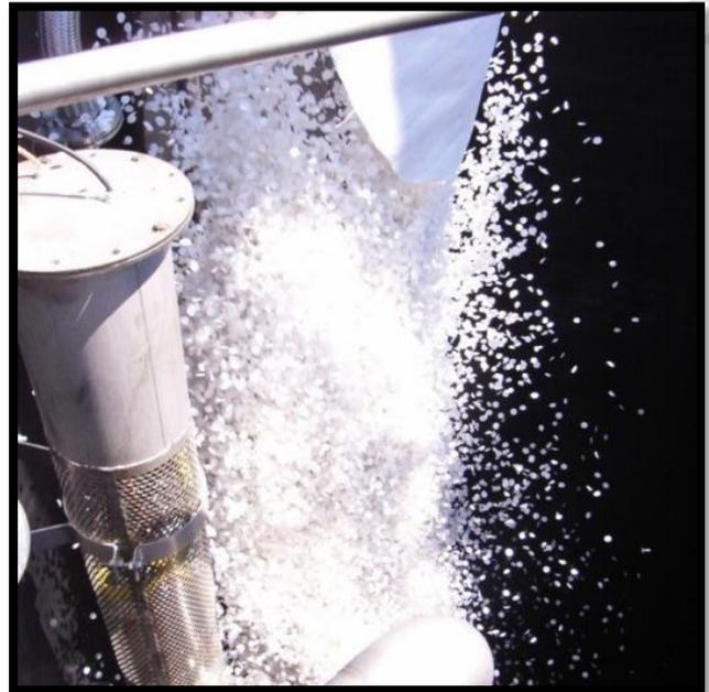
*Fig. 1: BigBag sendo cortado ao longo da borda da base; Fig.2: Mídias MixLife BioChip 30 caindo do BigBag*
