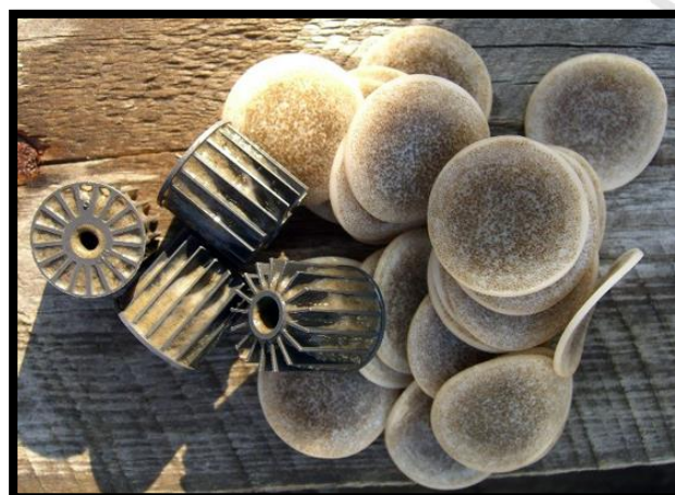
Fig. 3 Carreador com sinais de abrasão; Fig. 4 Para comparação: carreador entupido (esquerda) e biomídia do tipo chip (à direita)
