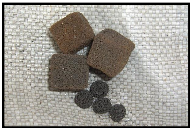
Fig. 1 Mídia de espuma virgem (esquerda) e desgastada (à direita); Fig. 2 Carreadores danificados por alta energia cinética (abrasão).
