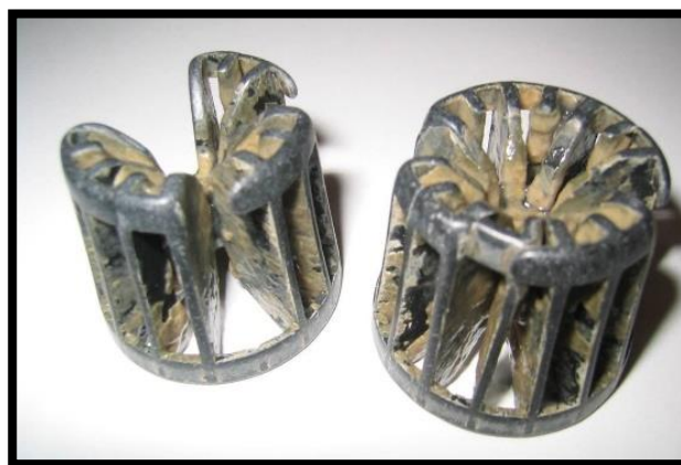
Fig. 1 Mídia de espuma virgem (esquerda) e desgastada (à direita); Fig. 2 Carreadores danificados por alta energia cinética (abrasão).
